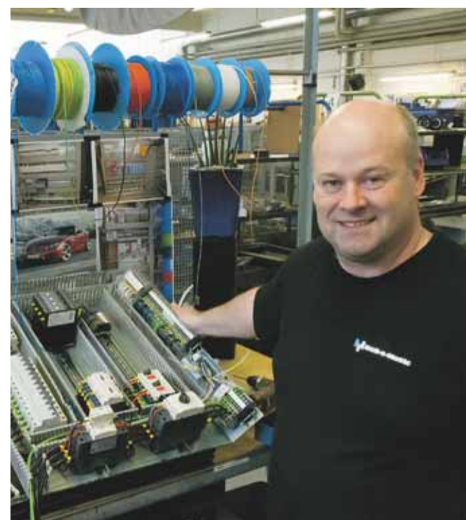
Industrielektriker Bent Kristensen, Roll-o-Matic A/S, er ved at montere en tavle til en maskine.
